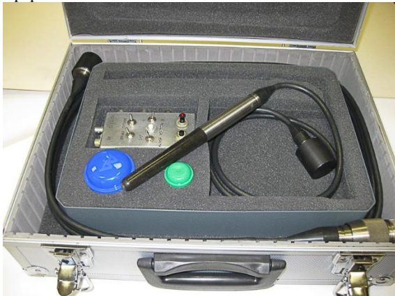
1-súwret: Suw astı fon shawqınların jazıp alıw ushın qollanılatuǵın arnawlı gidrofon úskenesi.
